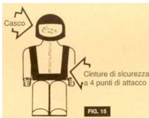
Naturalmente i punti di ancoraggio alla struttura del velivolo dovranno essere scelti in modo da dare adeguate garanzie di robustezza e tenuta. L'adozione di questo tipo di cinture assume particolare importanza in certe condizioni critiche di volo come:
